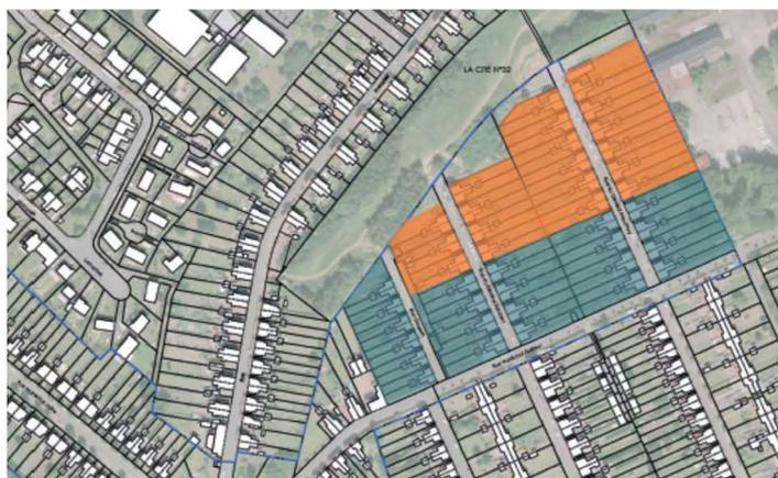
**Plan de masse de la tranche 3 des travaux de rénovation de la cité de la Victoire à Houdain** : zone dite « les 3 rues » dans laquelle en plus de travaux de rénovation de logements, il y a également un projet de démolition/reconstruction en cours de définition (en orange sur le plan).
