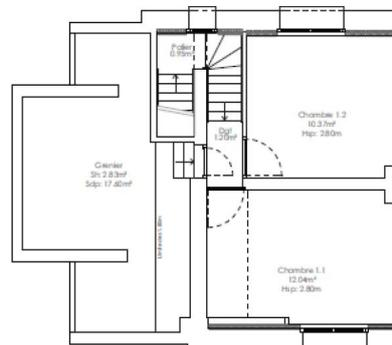
**Plan R+1 du logement T4 type G326 GX avant travaux**
