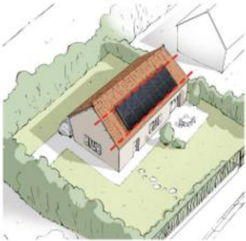
Alignement au faitage
