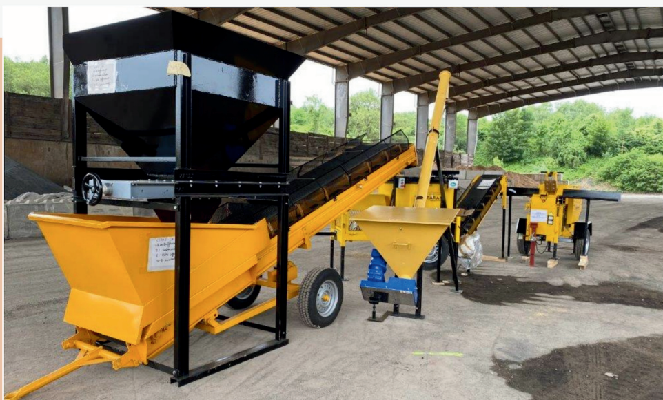
Exemple d'équipement semi-industriel de production de BTC - Crédit : Approtechno
