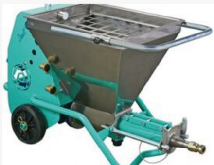
MELANGEUR COMPRESSEUR EAU - LIANT - BIOMASSE
