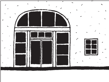
Ouverture sur séjour. Le linteau dissimule la dalle ou permet l'installation d'un volet roulant
