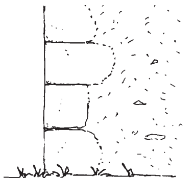
l'enduit vient affleurer le chaînage d'angle
