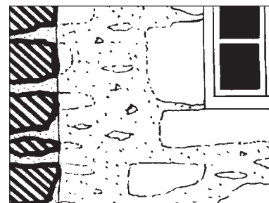
Joints à pierre vue
