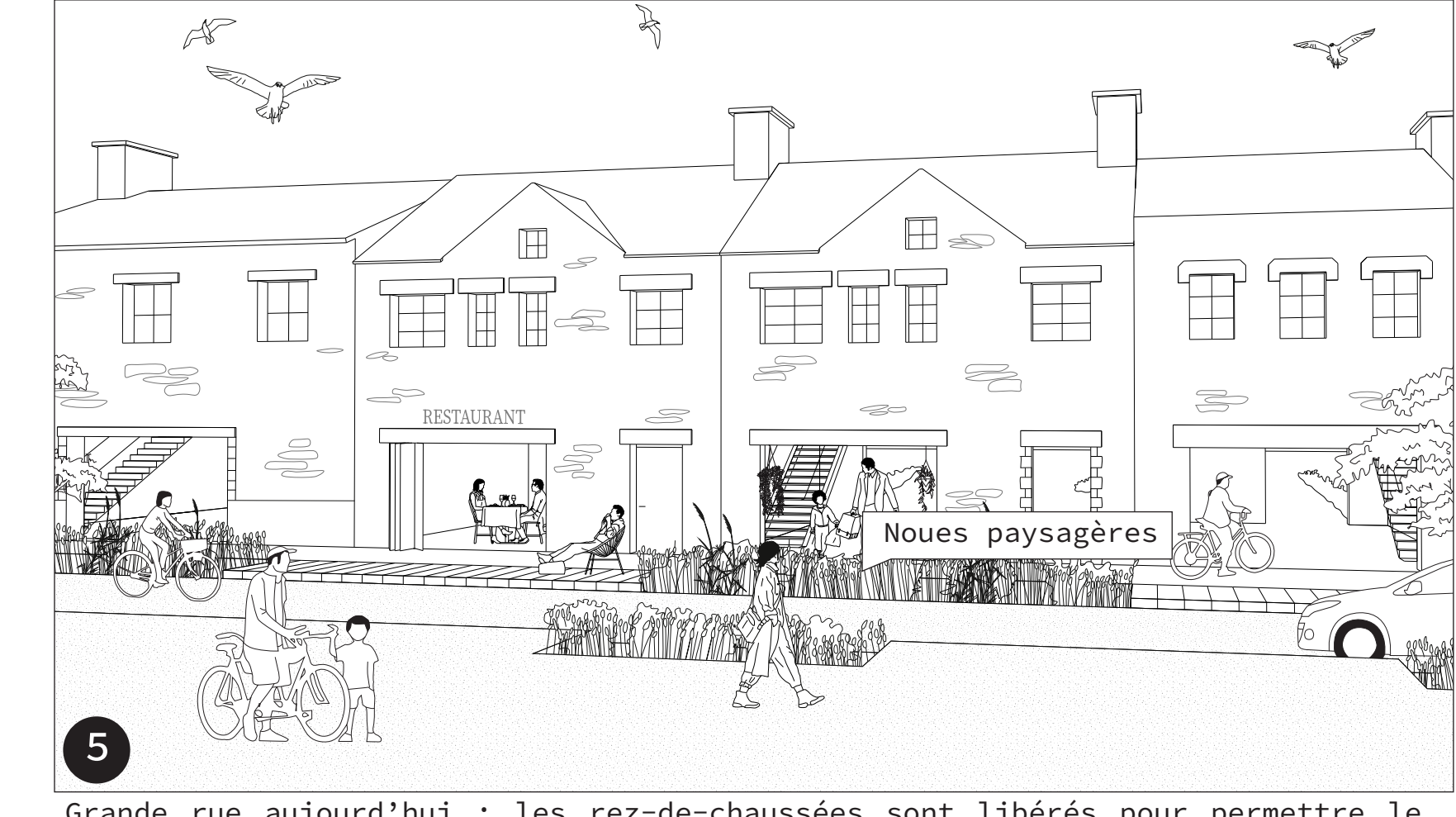
5 Grande rue aujourd'hui : les rez-de-chaussées sont libérés pour permettre le passage de l'eau lors des phénomènes de montée des eaux et accueillir ainsi de nouveaux usages
