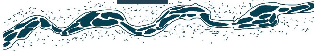
La renaturation est une technique qui s'effectue sur des zones où il n'est pas possible de modifier la forme du cours d'eau et où le gabarit rectiligne est conservé.
