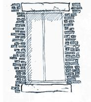
Linteau en béton préfabriqué
