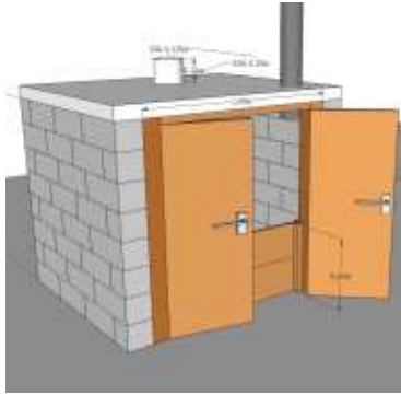
Plans et photos d'un composteur relié à une toilette avec un accès par une menuiserie étanche à double vantaux avec batardeau (amovible)
