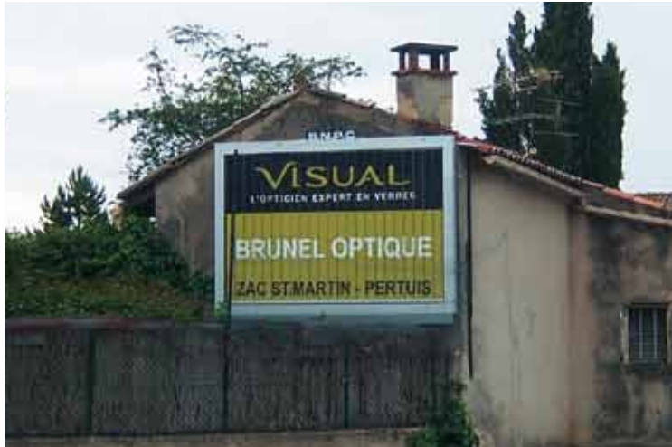
Dispositif publicitaire mural 4 m 2 , type "Trivision" qui permet de placer 3 visuels différents sur un seul support. Désormais, ce dispositif mural ne doit plus dépasser de l'égout du toit : il faudra donc le baisser ou le changer de mur.
