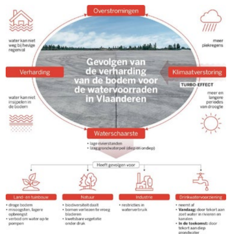
Gevolgen van verharding, overstroming zowel als waterschaarste Bron: Renson I., We spelen met water, De Standaard, 09.12.2019
