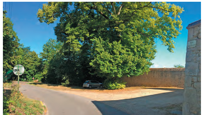
À Saint-Vaast-de-Longmont (60), le stationnement se fait sur le bas-côté enherbé, sous les arbres, contre le cimetière. La partie près de l'entrée, d'usage plus intense, est traitée en stabilisé.
