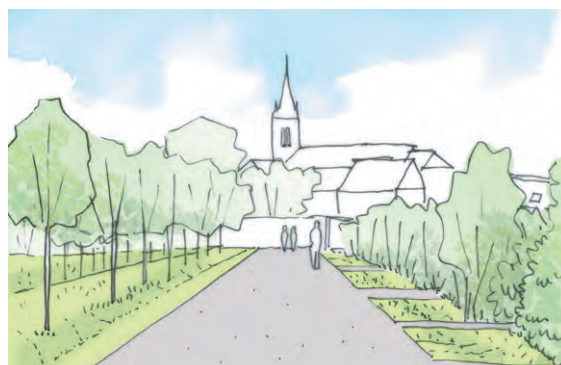
Bandes enherbées latérales pour l'infiltration des eaux de ruissellement au cimetière de Thoué-sur-Loire (44).
