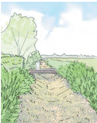
Noue d'infiltration enherbée et bordée de saules dans le cimetière paysager de Bondoufle (91).
