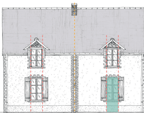
Façade avant (modénature briques)
