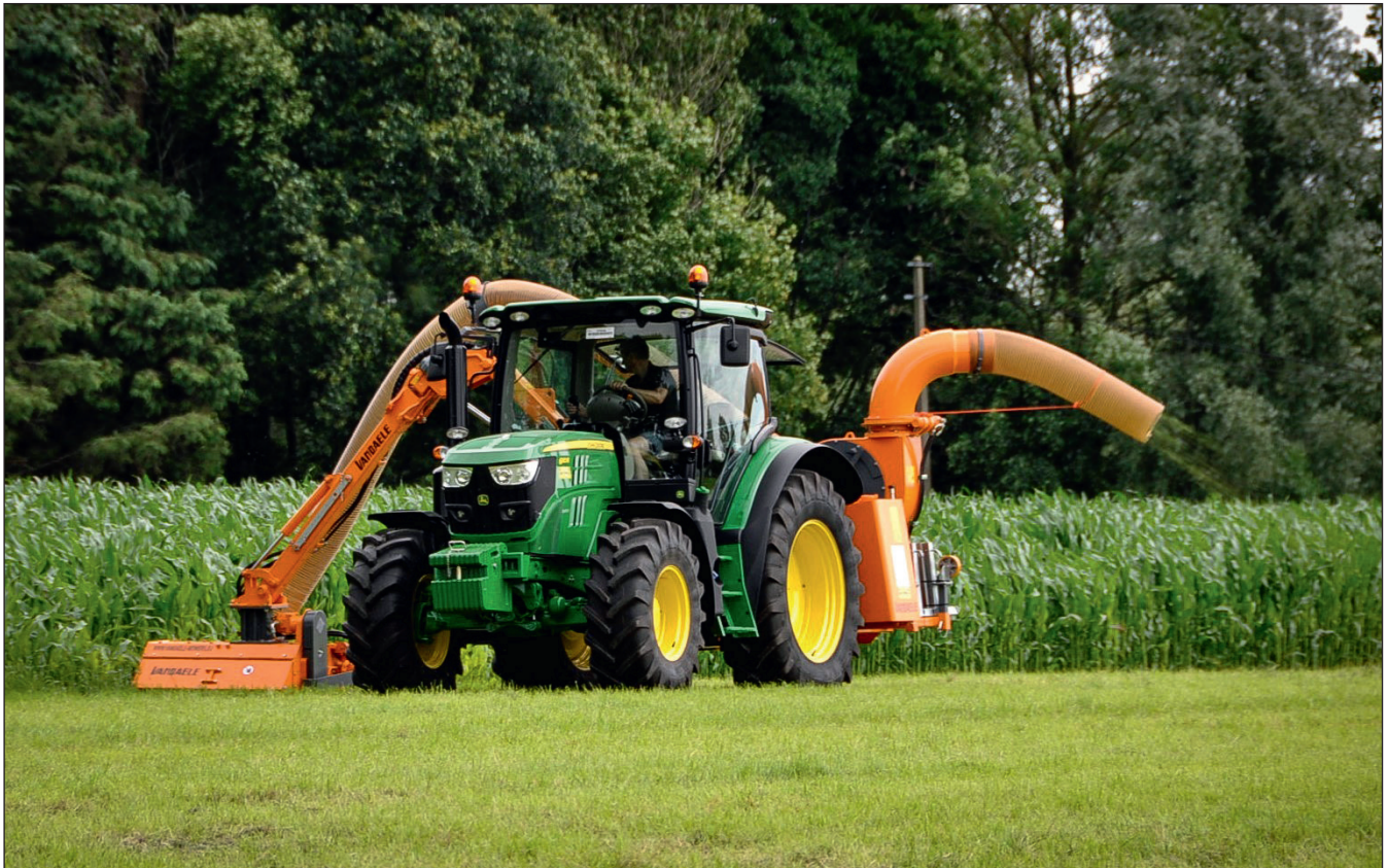
Figure 9: Faucheuse à fléaux adaptée pour évacuer les herbes fauchées vers le champ adjacent. (photo : Inagro)
