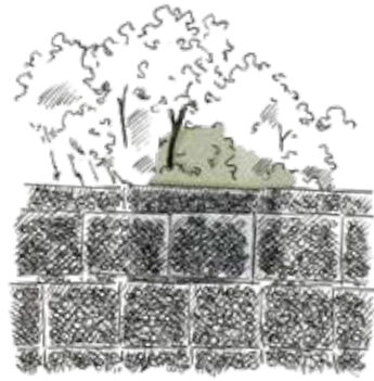
Soutènement en gabions
