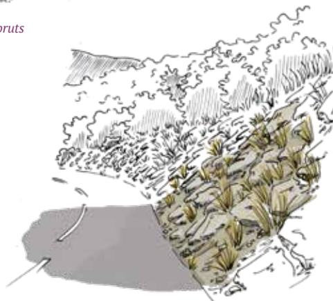
Talus stabilisé en pierre et végétalisé
