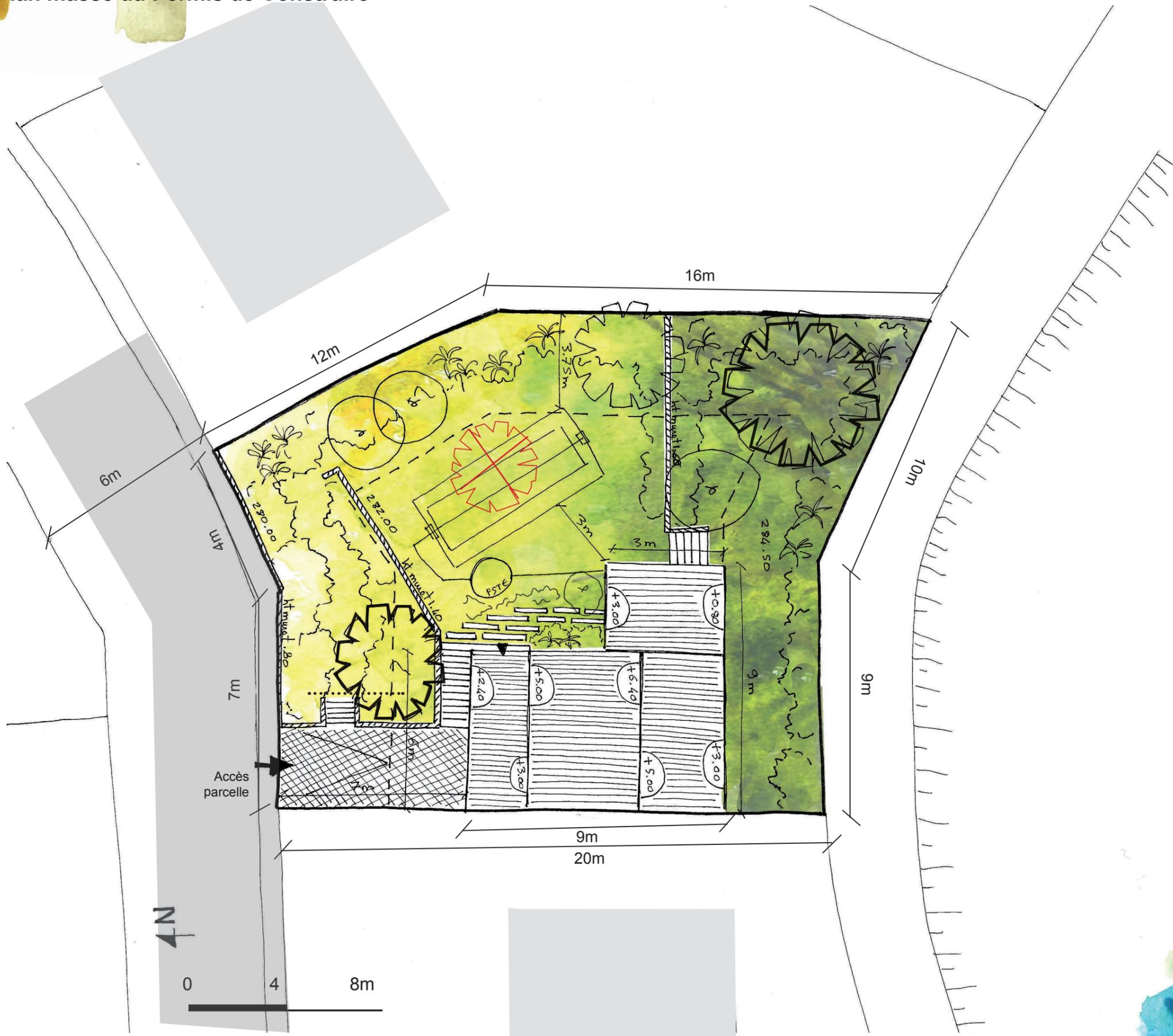
Sur un terrain en pente, les bouleversements du sol comme la création de plateaux soutenus par des murs de soutènement sont à représenter sur le plan masse et en coupe. La hauteur des murs de soutènement est réglementée dans le PLU.
