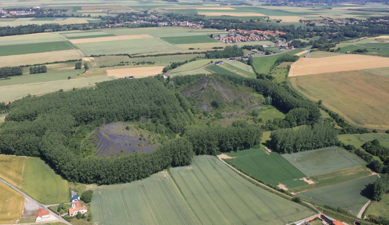
Vue aérienne vers le nord depuis Ligny-lès-Aire. À droite le terril 31, avec vue sur l'empreinte de la rampe de chargement et les restes du terril 31a. À gauche, le terril 32, tronqué. Le boisement marque l'emplacement du carreau de la fosse 2. Entre ces terrils passent une ancienne voie ferrée. © DREAL Hdf 2020 – Ph. Frutier
