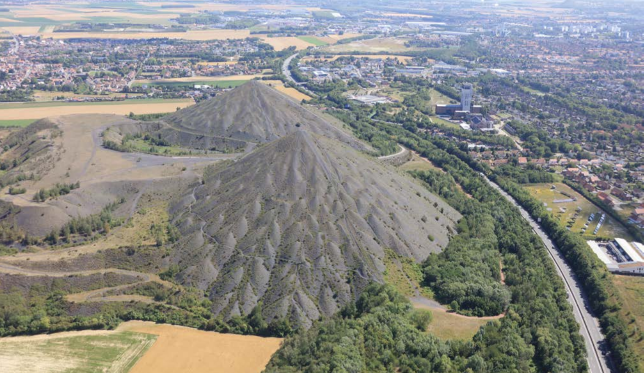
Vue aérienne vers le nord-est depuis Loos-en-Gohelle. Vue sur les microreliefs en forme d'épi et l'emplacement de la rampe de chargement du terrill 74. À droite, la fosse et ses chevalements séparés des terrils par l'autoroute A21. © DREAL HdF 2020 – Ph. Frutier
