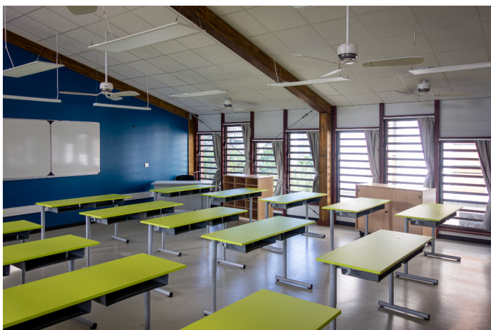
Les salles de classe largement ouvertes et ventilées, avec brasseurs d'air et système d'éclairage performants.
