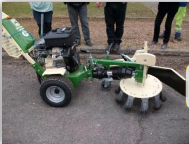
Porte-outils avec brosses rotatives et bac de ramassage
