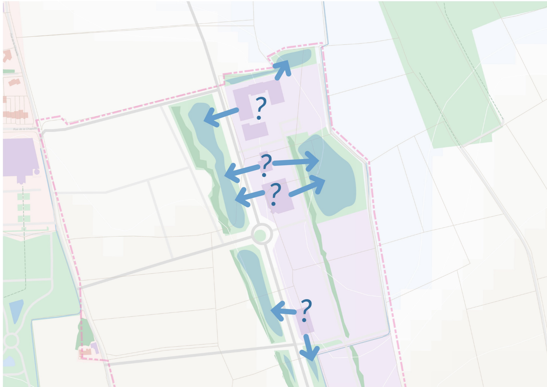
Proximité des bâtiments avec les ouvrages d'infiltration et de tamponnement de la Zone d'Activité Croix Rouge B
