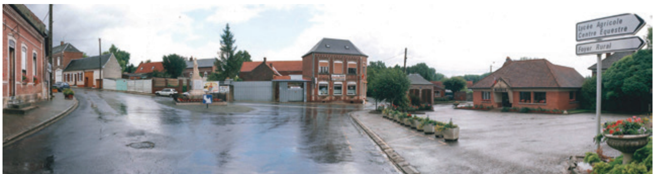
Sur la place de la mairie avant aménagement, une large emprise est dévolue à la circulation automobile. Des trottoirs sont occupés par le stationnement, un îlot directionnel entoure le monument aux morts.
