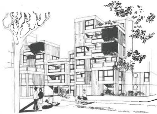
La gradation des décalages et des portes à faux que permet le portique se prête aisément à des combinaisons multiples de volumes. Saillies, balcons, bow windows, bien appropriés par leur échelle à la dimension du logement et à l'espace de la rue.
