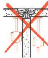
Aucune implantation positionnement par pivots de centrage
