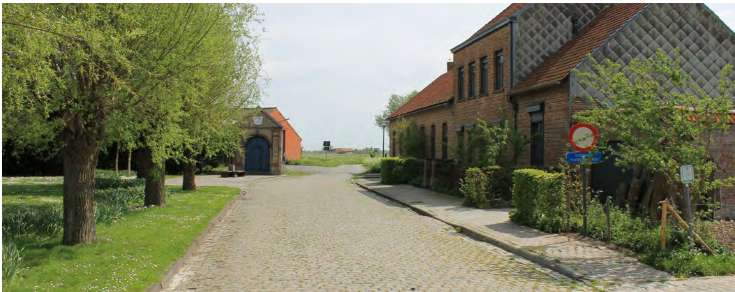
^ Door gebruik te maken van verschillende materialen in een gelijke kleur voor de weg en het voetpad is het straatprofiel leesbaar en sober.
