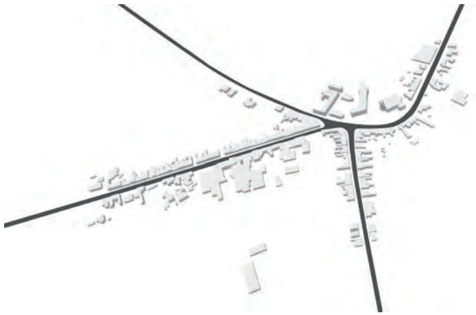
▲ Structuur van een straatdorp (vb: Pervijze). De bebouwing is georganiseerd langs een centrale straat.
