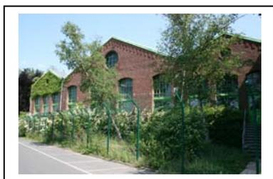
**La salle des ventilateurs** est de plan rectangulaire et se compose de trois bâtiments accolés, édifiés sur un seul niveau en maçonnerie de briques et surmontés d'une toiture à deux pans. La façade frontale présente un large mur pignon flanqué de deux murs pignons de dimensions inférieures. Quatre longues baies pourvues d'une traverse percent le pignon central. Un oculus surmonte l'ensemble de ces baies.
