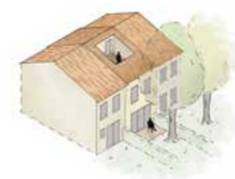
terrasse dite « tropézienne », avec une largeur de toiture conservée sur chaque côté pour maintenir une continuité avec les toitures voisines
