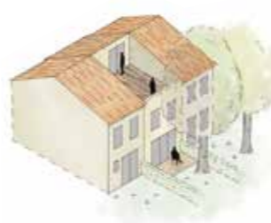
terrasse créée par la suppression complète du versant arrière de toiture
