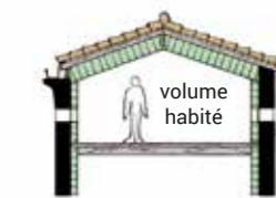
isolation sous toiture
