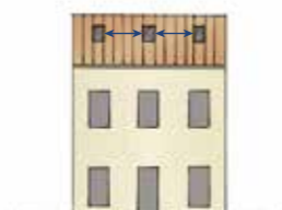
principe d'implantation des fenêtres de toit
