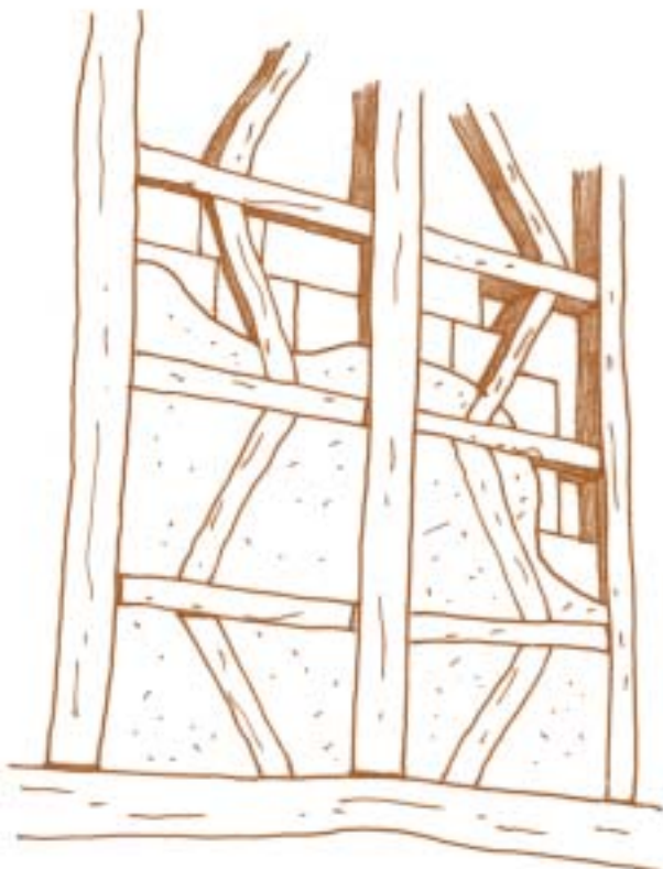
Remplissage et enduit
