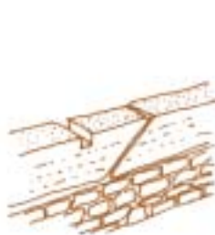
Préparation pour les banchées supérieures
