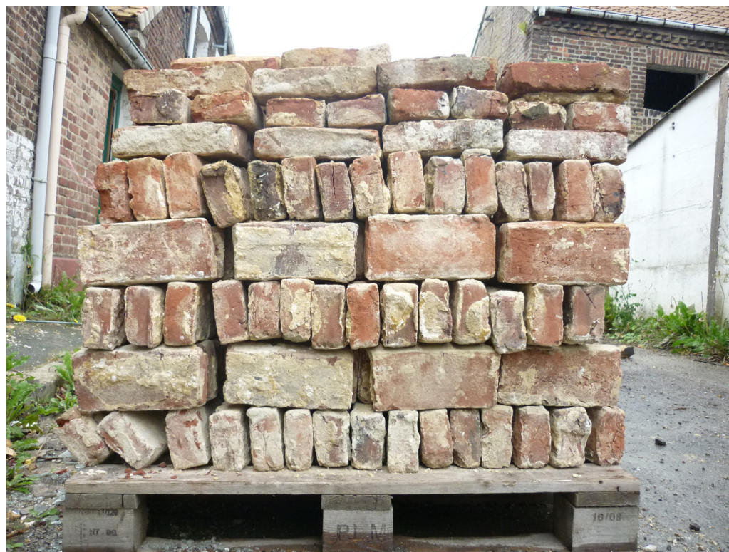
Récupération de briques issues de démolition pour réemploi, Cité des electriciens - AAPP architectes
