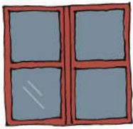
Baie 1/1. Percement privilégié aux étages bas de plafond comme les combles.
