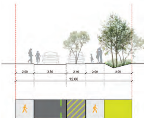
PROFIL TYPE voie simple sens - desserte de l'îlot
