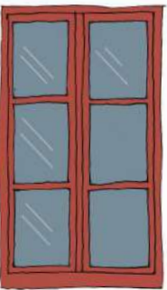
Baie 1/2 voire 1/3. Percement privilégié aux étages courants, en fonction de la hauteur sous plafond. Luminosité plus grande.
