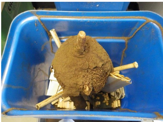
Figure 19 : éléments d'essais exposés à proximité d'un nid de Nasutitermes ephratae ; Bordeaux
