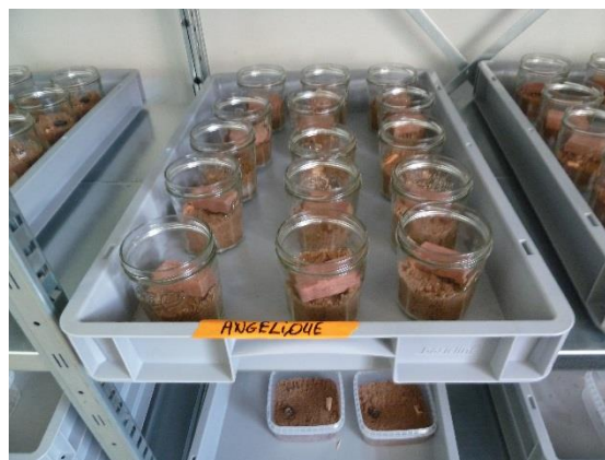
Figure 10 : essai selon NF EN 117 adaptée en fonction des ressources locales ; Cayenne
