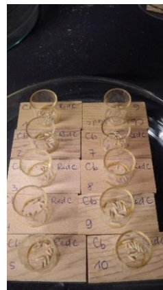
Figure 14 : essai selon NF EN 117 adaptée pour le genre Cryptotermes ; durabilité naturelle avec 10 répétitions ; Bordeaux
