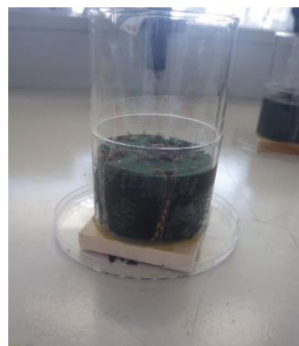
Figure 16 : essai selon NF EN 118 adaptée pour le genre Nasutitermes ; Bordeaux
