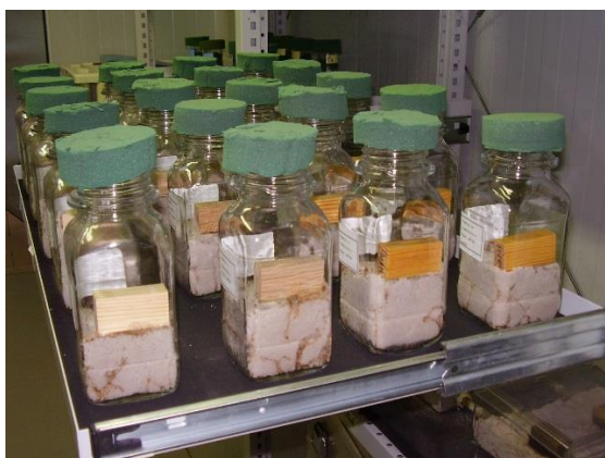
Figure 9 : essai selon NF EN 117 ; FCBA Bordeaux
