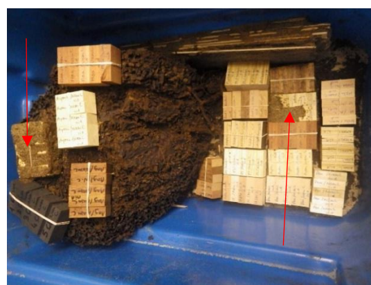
Figure 16 : essai selon NF EN 118 adaptée pour le genre Nasutitermes ; Bordeaux
