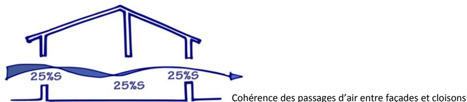
Note : Une ouverture latérale (type ouverture de pignon) complémentaire au système pneumatique traversant (prioritaire) pourra changer le parcours fluide traversant et permettre un ajustement conjoncturel de l'irrigation, mais ne devra jamais (réglage) shunter le mécanisme principal.
