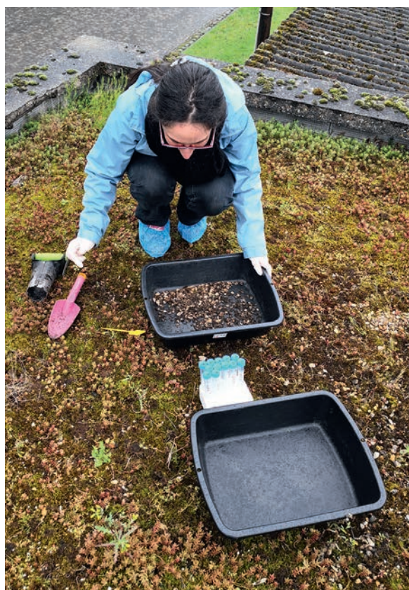
« Pooling » des 10 échantillons de sol sur la toiture du bâtiment technique du Conseil départemental du 93. © Marc Barra | ARB idF
