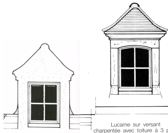
Lucarne sur versant charpentée avec toiture à 3 p Lucarne maçonnée à fronton au nu du mur de façade. rare capucine
