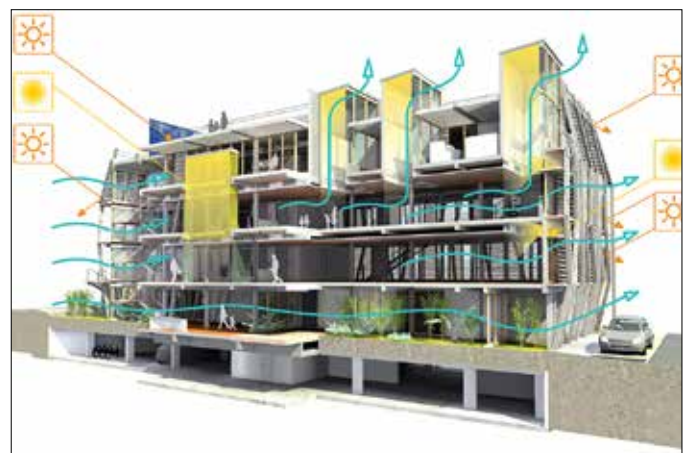
L'aéraulique des espaces internes repose sur une transparence horizontale maximum, complétée par des extractions verticales en toiture.
