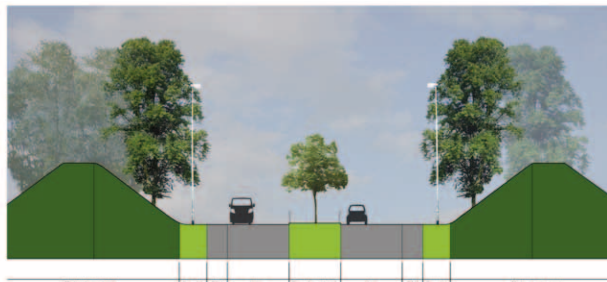
Requalification de la RN 184 Avec la construction de l'A 104, la RN 184, voie autoroutière en pleine ville, sera désengorgée. La diminution du trafic permet de requalifier la nationale aujourd'hui épaulée et occultée par des merlons de protection. Un boulevard urbain est ainsi envisageable sur une partie du tracé, donnant lieu à des façades de part et d'autre de la voie qui devient aussi accessible à d'autres modes de transports plus respectueux de l'environnement.
