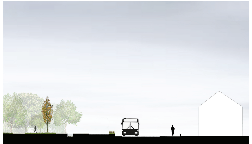
Coupe témoignant de l'investissement des REZ du côté de la place commerçante et de la différence de niveau vis à vis de la rue
