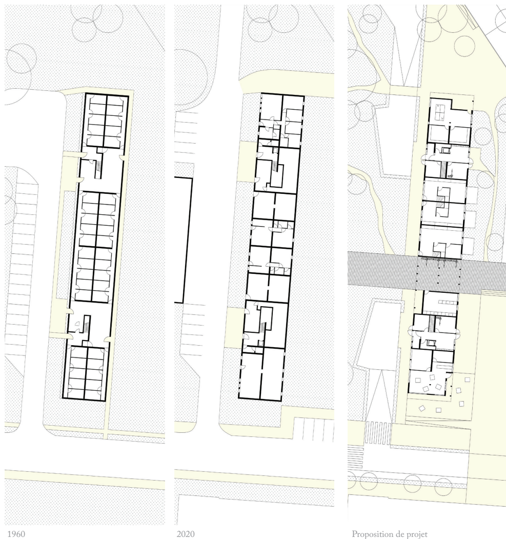
Comparaison du REZ entre le plan des caves d'origine, le plan actuel et le plan du projet
