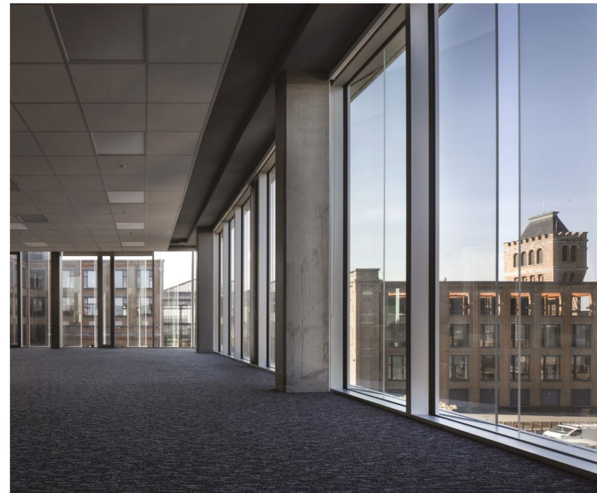
La structure interne du bâtiment de type poteau-dalle alvéolée précontrainte (DAP), combinée à un système de rafraîchissement-ventilation-chauffage ingénieux intégré dans l'épaisseur du complexe dalle structurelle/plancher technique, permet de libérer à chaque niveau un plateau entièrement modulable, dégagé de poteaux et de réseaux. La vue dégagée, la générosité des espaces et le plafond en béton peint en gris réaffirment la qualité du confort visuel et à la luminosité.
