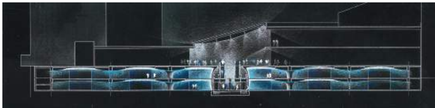
Véritable architecture souterraine conçue sur une trame de 16 x 9 m., le parking est lié à une importante opération de rénovation urbaine de centre-ville.
