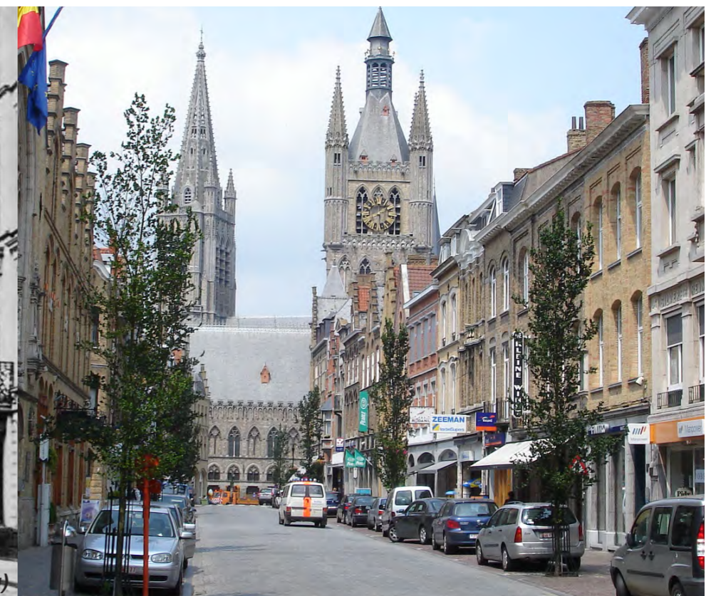
Het wegsnijden van de uitstulping van het bouwblok ten westen van de Rijsselstraat was zowel een rooilijnwijziging om zowel verkeerstechnische als esthetische redenen. De bocht vanuit de Boterstraat was daardoor gemakkelijker te nemen en vanuit de Rijsselstraat kreeg men hierdoor een breder zicht op de Lakenhal. De recente boomaanplant doet hier licht afbreuk aan.
