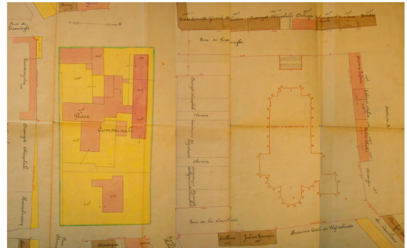
Deelgebied uit het rooilijnplan van Wijtschate, getekend door architecten Leborgne in 1922, en goedgekeurd in 1924. In dit uitgevoerd ontwerp wordt alleen de oriëntatie van de kerk wat bijgestuurd. Belangrijker is dat een helder afgelijnde "place communale", waarop het gemeentehuis centraal uitteeft, ontworpen werd, en een afzonderlijk kerkplein.
