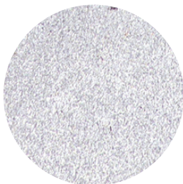
Enrobé à granulats calcaires grenailé*
