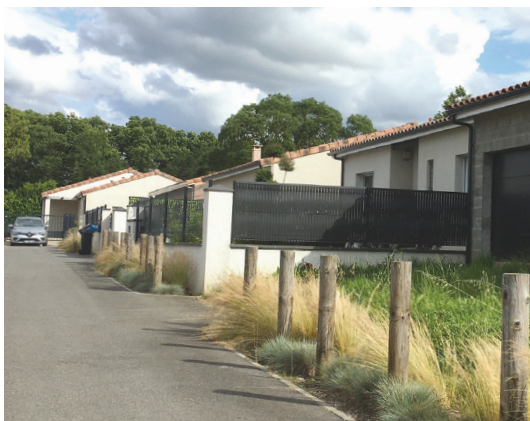
Saint-Hilaire / Plantations de graminées et potelets bois qui donnent son identité au quartier, murets implantés en recul d'environ 75 cm de la voie.
