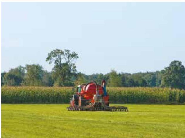
L'épandage du digestat par pendillard permet de limiter les émissions d'ammoniac.
