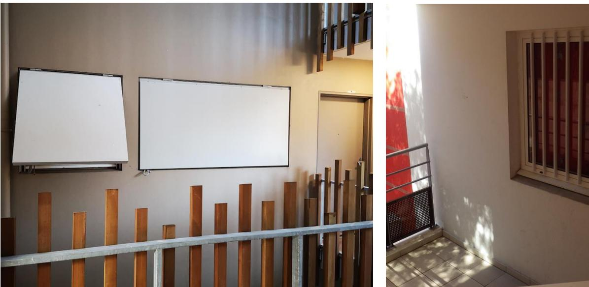
Les portes d'entrées peuvent être doublées d'une grille permettant de laisser sa porte pleine ouverte pour laisser le flux d'air ventiler le logement.
