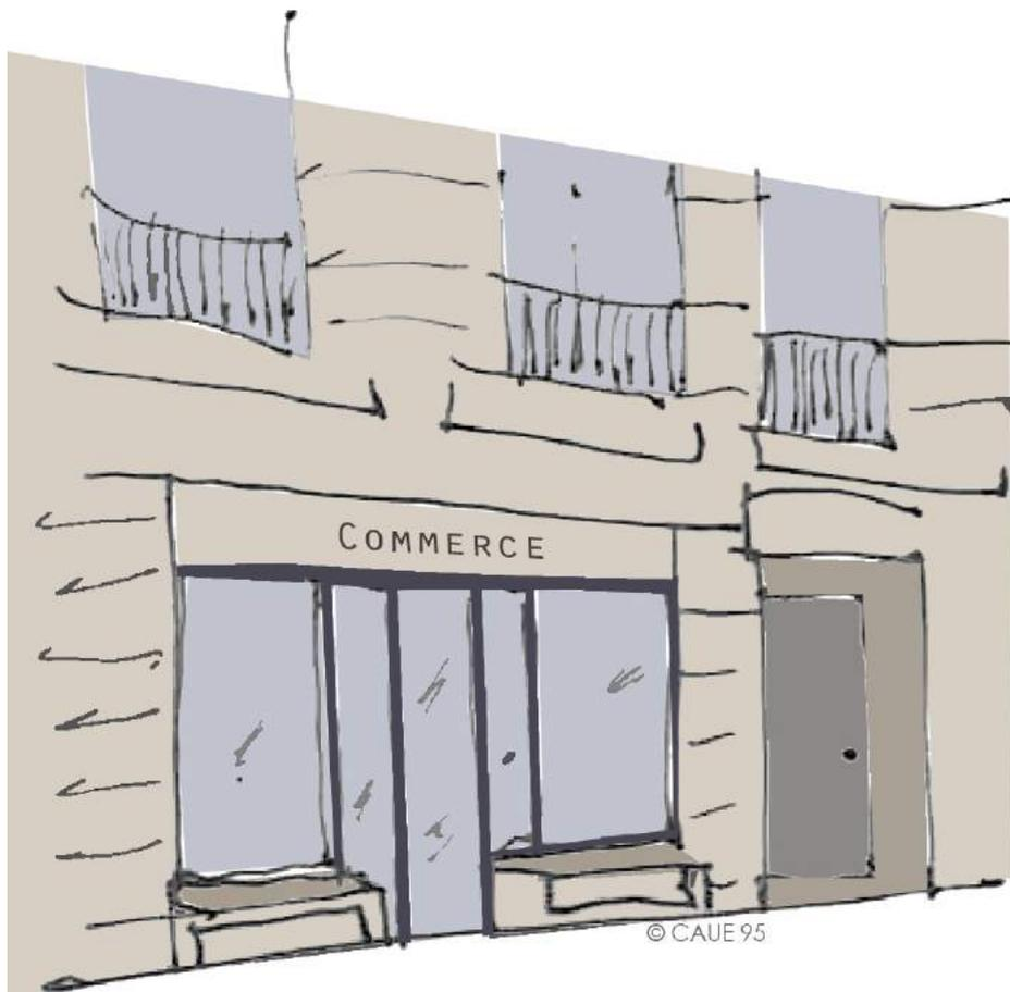
La devanture en feuillure se caractérise par une insertion de la vitrine dans l'épaisseur du mur. Elle est placée à l'intérieur de la baie de l'immeuble et se situe donc en retrait du nu extérieur de la façade. Les parties pleines de la devanture correspondent aux couleurs, matériaux et éléments architecturaux de la façade de l'immeuble.
