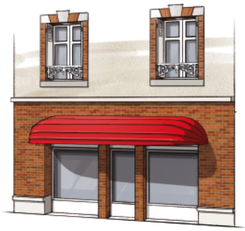
Les stores corbeilles ont une forme inadaptée à l'architecture.
