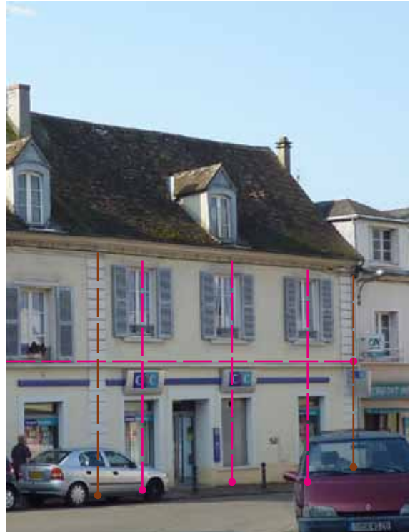
La devanture respecte la composition de la façade et s'inscrit sous le bandeau horizontal qui marque la limite entre rez-de-chaussée et 1er étage
