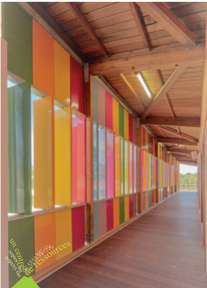
△ De larges baies protégées et des allèges basses procurent un confort visuel appréciable pour les marmailles.
