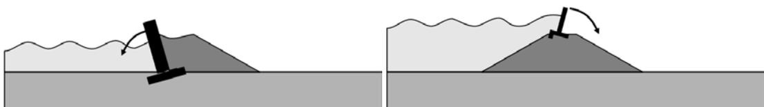
Figure 3.189 **Basculement de murs dans des digues composites dû aux tassements différentiels**
