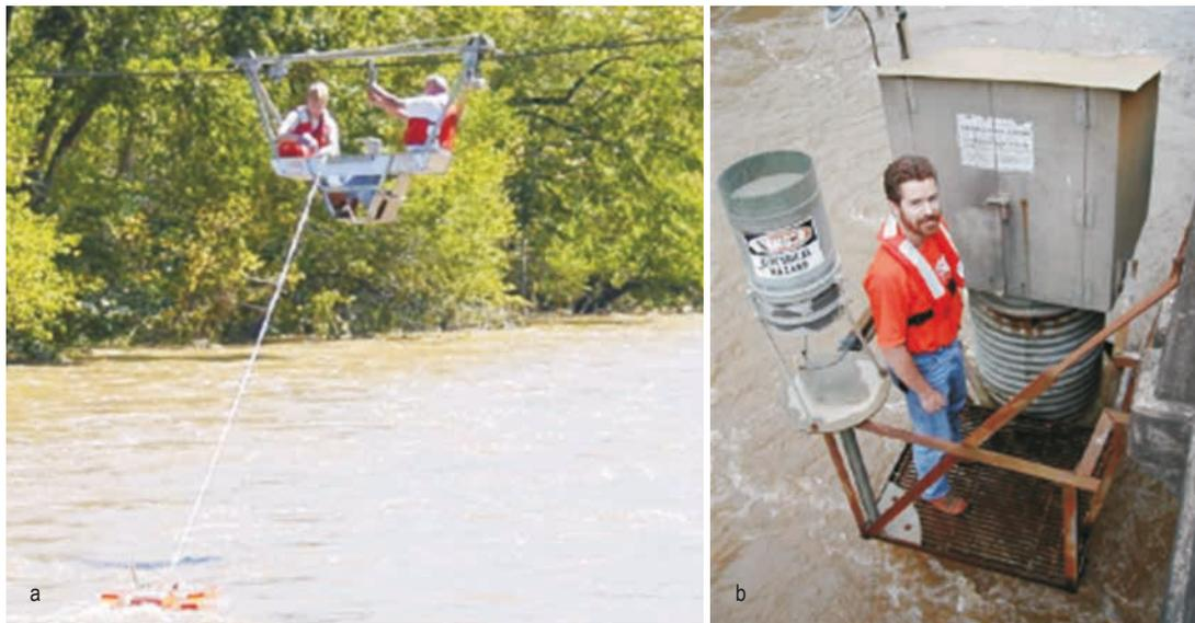
Figure 7.19 **Mesure directe des écoulements par des dispositifs de jaugeage utilisant un Acoustic Doppler Current Profiler (ADCP) (a) ou une plateforme de collecte des données de terrain pour la mesure des débits et des précipitations (b)**
