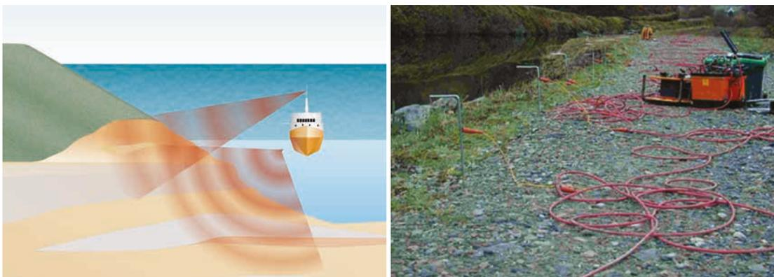
Figure 7.73 **Méthodes de surface : tomographie de résistivité électrique**
