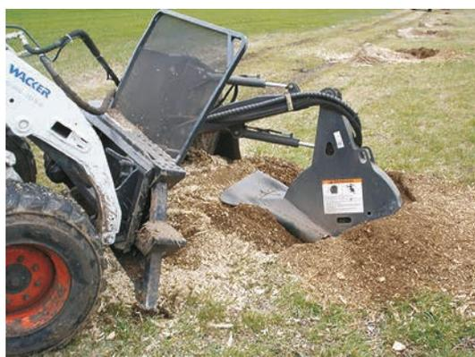
Figure 10.51 **Broyage et tronçonnage des souches, ainsi que comblement des trous laissés par les souches au niveau et à proximité de la digue**
