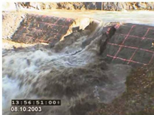
c Désagrégation du sol - détachement d'un bloc sur le côté gauche de la brèche
