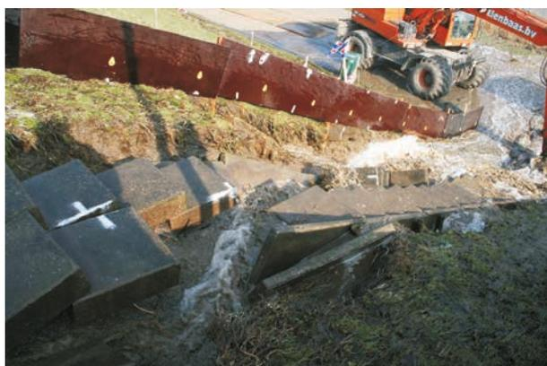
Figure 4.14 Test de résistance d'une digue comportant des escaliers, aux Pays-Bas
