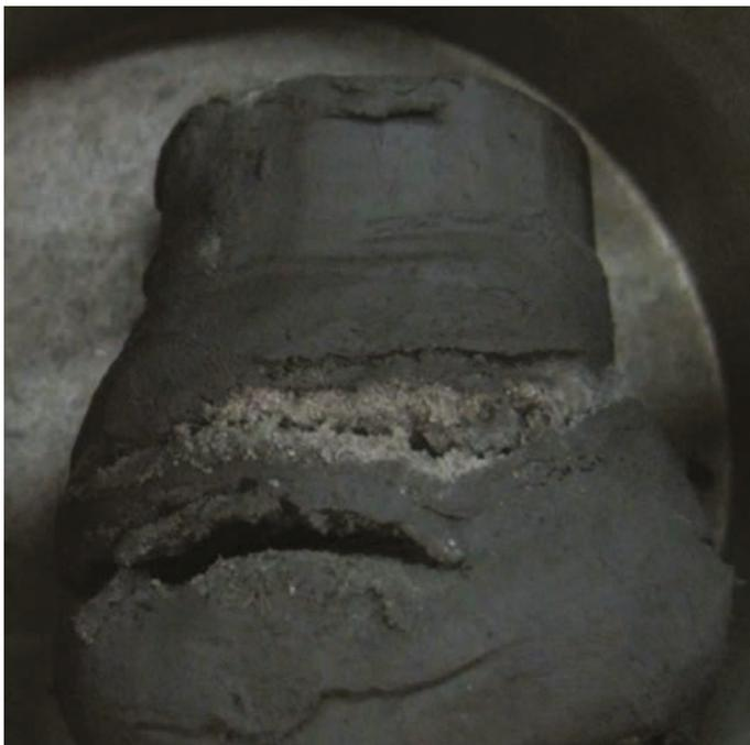
Figure 9.94 **Échantillon d'argile contenant des lentilles sableuses**
