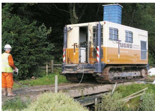
**Appareil de forage CPT à faible pression au sol**
