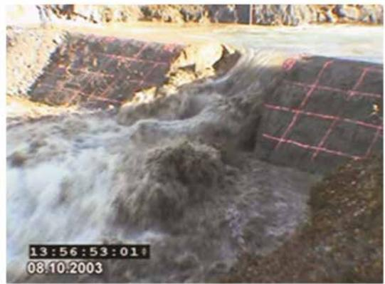
d Désagrégation du sol - détachement d'un bloc sur le côté gauche de la brèche deux secondes après une brèche par détachement de bloc (le bloc a été emporté)
