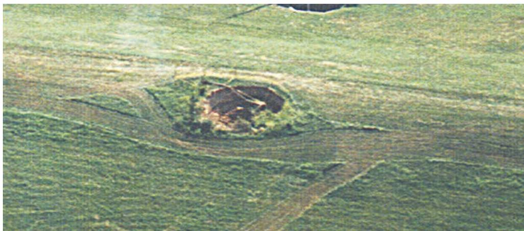
Figure 4.56 Cavité d'effondrement apparue lorsque deux canalisations en métal ondulé de 1,8 m de diamètre se sont effondrées sous une digue de l'Indiana, aux États-Unis
