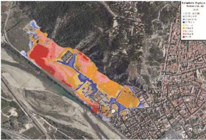
**Figure 8.143 Exemple de zonage des hauteurs d'eau trente minutes après une rupture de digue dans une zone urbaine**
