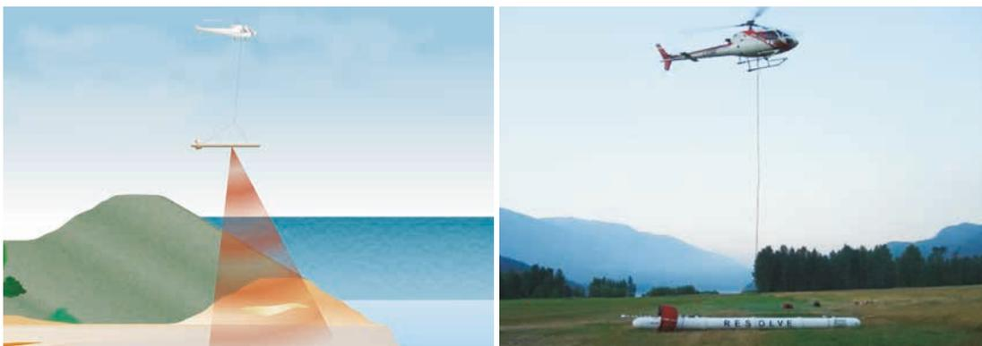
Figure 7.75 **Méthodes aéroportées – mesures EM de domaine fréquentiel**
