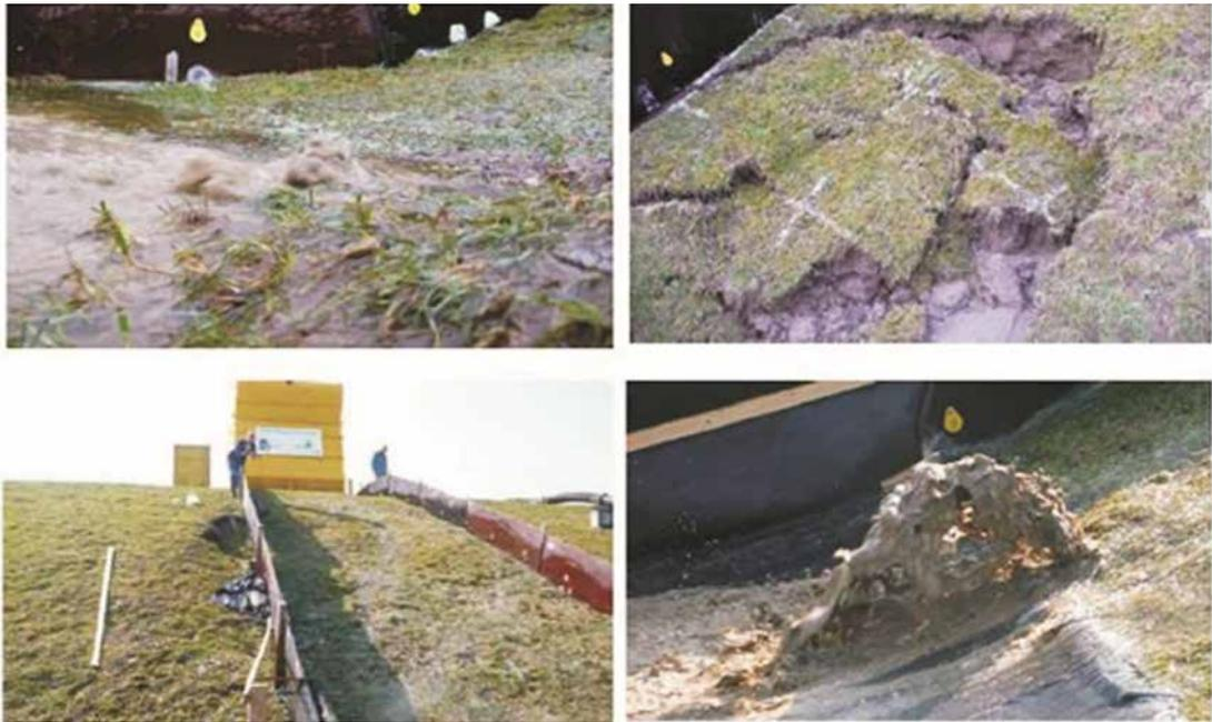
Figure 8.50 **Études néerlandaises récentes sur les performances de l'enherbage en conditions de surverse par paquets de mer, utilisant le simulateur de paquets de mer**
