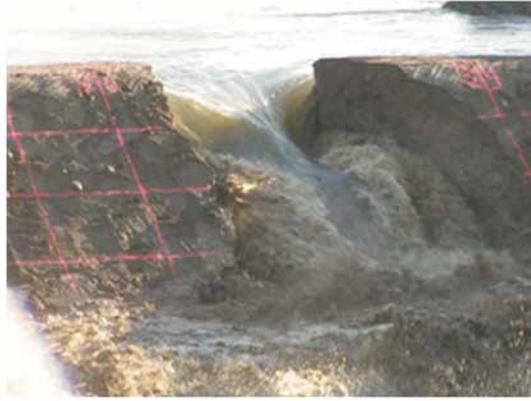
a Érosion de surface par des écoulements turbulents à la base des côtés d'une brèche
