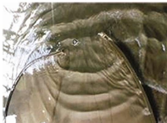
Figure 7.47 Réfraction, shoaling et déferlement de vague (source : USACE)
