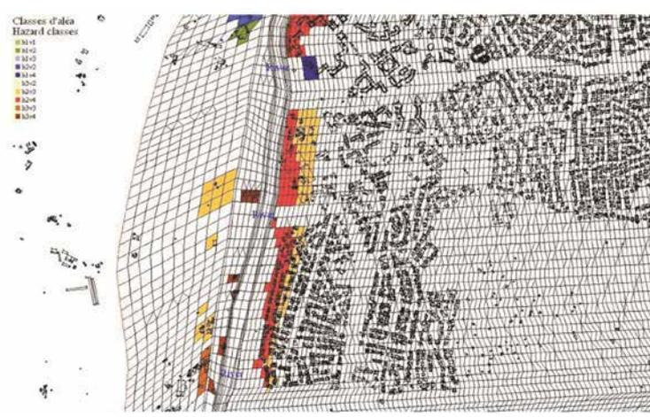
Figure 8.150 **Carte d'inondation montrant les zones de risque élevé lié à une rupture de digue, calculée à partir d'un modèle hydraulique 2D**
