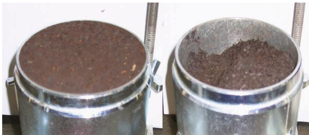
Figure 9.86 **Détermination de l'érodabilité d'une argile organique ; photos prises avant et après application d'un jet d'eau sous pression**
