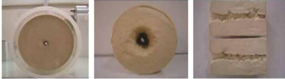
Figure 8.66 Exemple d'élargissement du conduit initial par érosion sur un échantillon de kaolinite blanche, échantillon avant l'essai (a), échantillon après l'essai (b) et section longitudinale de l'échantillon après l'essai (c)
