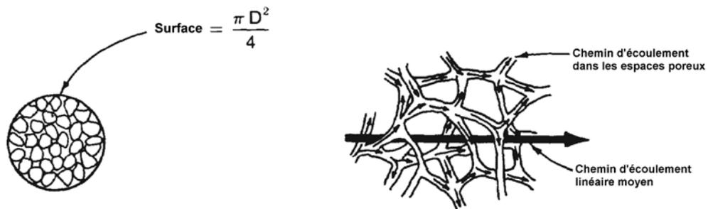
Figure 8.32 Concepts de chemins d'écoulement à travers une colonne de sol (source : USACE, 1993)
