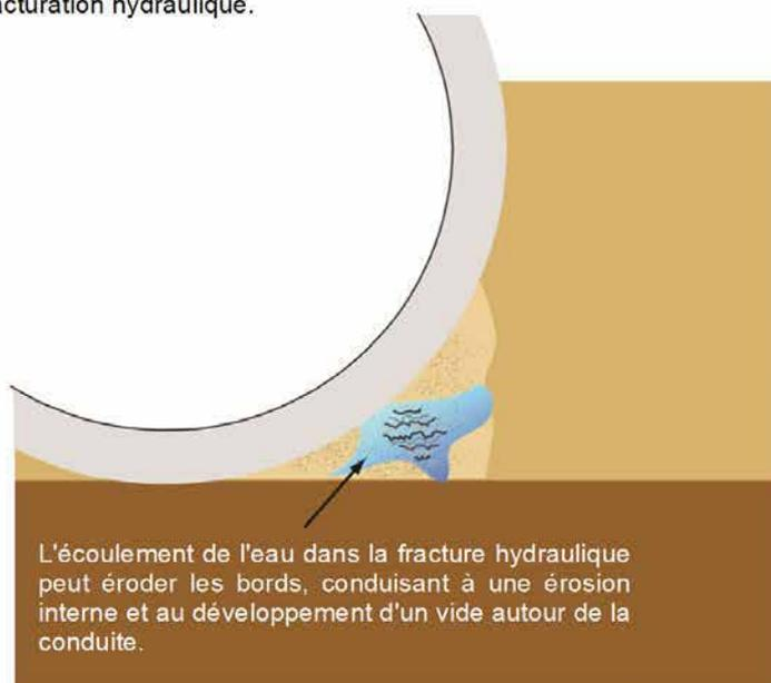
La fracture hydraulique peut se propager vers l'aval et initier une fuite depuis le réservoir.
