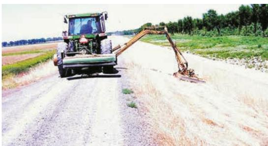
Figure 4.18 **Fauchage mécanique de l'herbe, en Californie, États-Unis – talus de digue en saison sèche**
