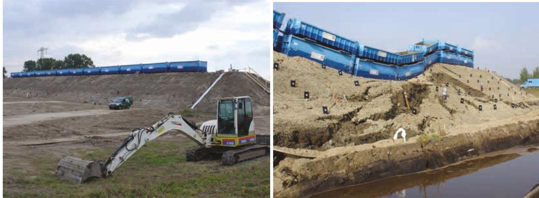
Figure 7.84 **Test d'IJkdijk en 2008 (a) digue avant la rupture et (b) digue après la rupture**
