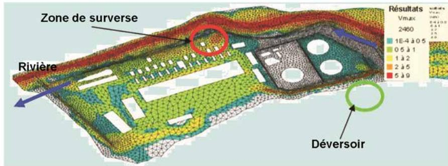
Figure 8.151 Exemple de carte d'inondation montrant les vitesses maximales dues à la surverse, calculées par un logiciel de calcul 2D aux éléments finis (Telemac) pour lequel le maillage de calcul est montré (Egis Eau pour EDF PEI, 2009)
