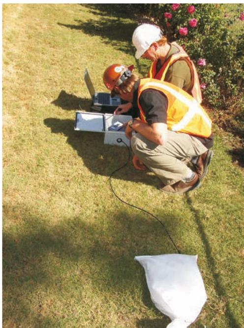
Les activités de construction d'une digue à proximité d'habitations ou d'autres ouvrages peuvent nécessiter un suivi de l'effet des vibrations provoquées par les travaux de construction. L'utilisation d'équipements lourds à proximité de telles structures provoque des inquiétudes quant à un dommage potentiel. En général, un suivi des vibrations peut aider à déterminer une responsabilité potentielle ou à dégager une responsabilité liée à des réclamations fantaisistes.
