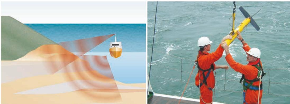
Figure 7.74 **Méthodes aquatiques – sonar à balayage latéral « poisson »**
