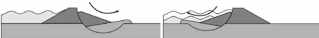
Figure 3.184 **Glissement rotationnel profond d'une digue**
