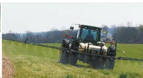
Figure 4.19 **Application mécanisée d'un herbicide anticotyloédones sur le talus herbacée d'une digue**
