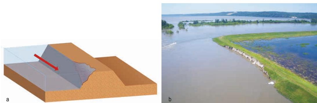
Figure 6.27 **Affouillement sur une digue, schéma (a) et image de terrain (b)**
