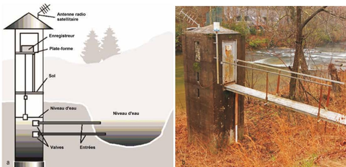
Figure 7.20 **Représentation schématique (a) et photographie (b) d'une installation classique de mesure de cours d'eau**
