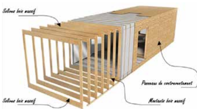
1. Principe constructif et structurel, © AIR Architectures.
