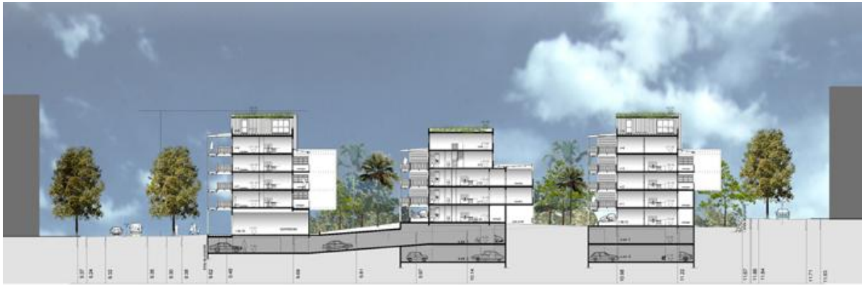
Fig. 37 : Coupe NORD-SUD de l'îlot Saint Jacques montrant les coursives et les cœurs d'îlot arborés
