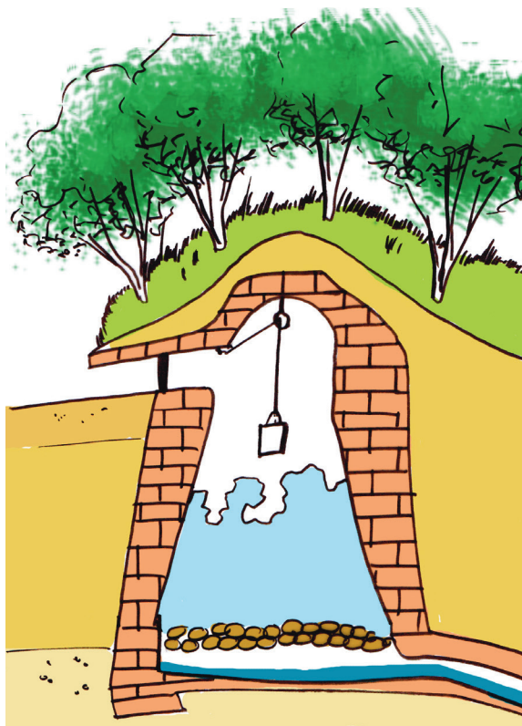
Schéma de fonctionnement de la glacière. La glace récoltée en hiver sur la serpentine y était stockée, et conservée tout l'été.
